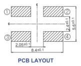
DIMENSION : mm STANDARD TOLERANCE : .X (1 PLACE) : ±0.2
