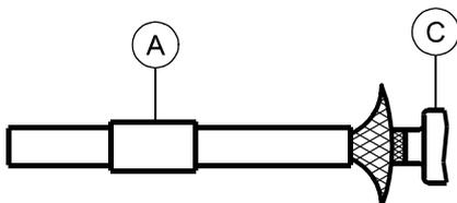
Abschirmung leicht aufspreizen und Kabel in Gehäuse C einführen.
