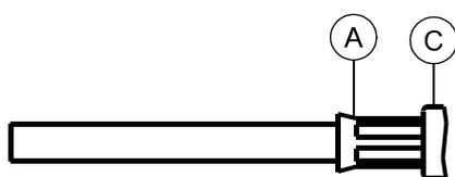
Hülse A über Abschirmung schieben und möglichst nahe am Gehäuse C klemmen.
