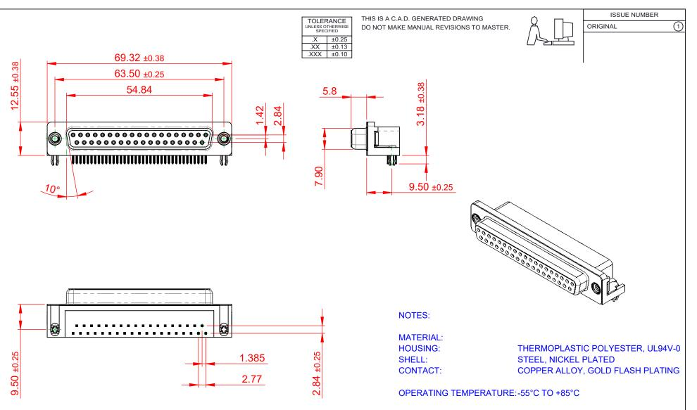
CURRENT RATING:3A ICONTACT RESISTANCE:25mINSULATOR RESISTANCE:500DIELECTRIC25m
