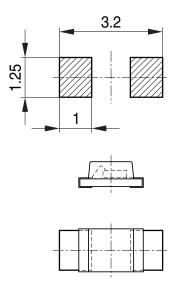
Bauteil positioniert Component location on pad OHFP2578
