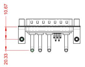
**OPERATING TEMPERATURE:** -55°C ~ 125°C POWER/CO-AX CONTACT RATING:
