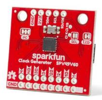
SparkFun Clock Generator Breakout - 5P49V60 (Qwiic)
