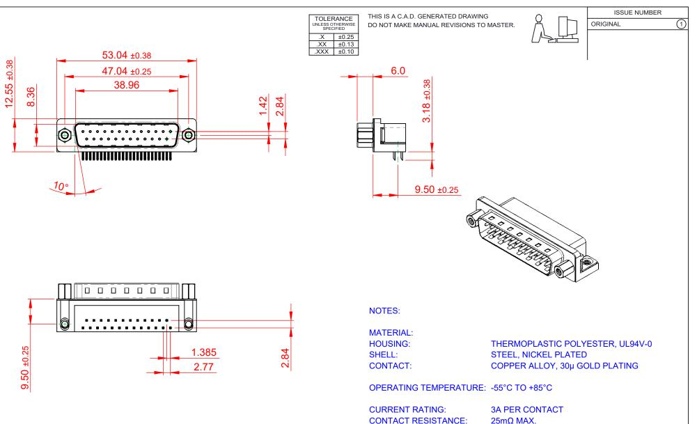
CONTACT RESISTANCE: 25mΩ MAX. INSULATOR RESISTANCE: 5000MΩ min.
