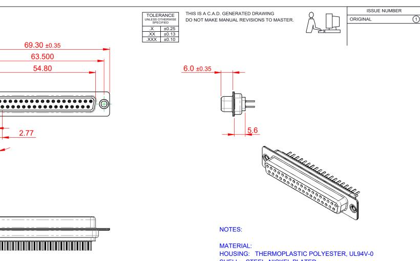
SHELL: STEEL, NICKEL PLATED CONTACT: COPPER ALLOY, 15µ GOLD PLATED OPERATING TEMPERATURE: -55°C to +105°C
