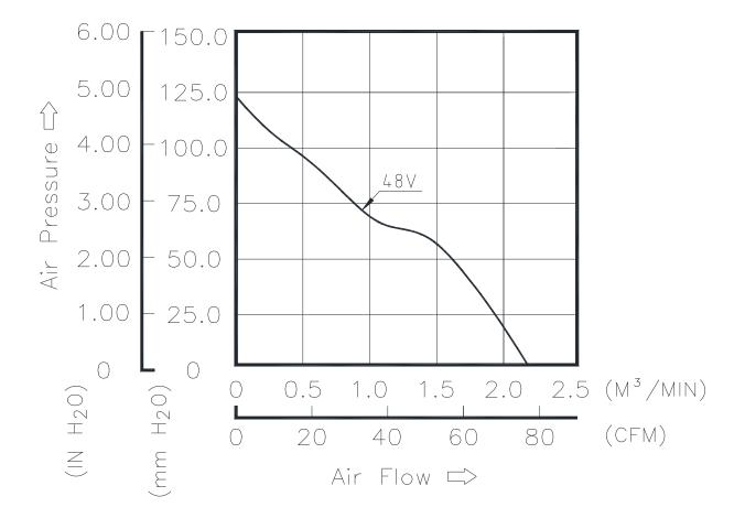
\*TEST CONDITION: INPUT VOLTAGE-----OPERATION VOLTAGE TEMPERATURE-----ROOM TEMPERATURE HUMIDITY-----65%RH
