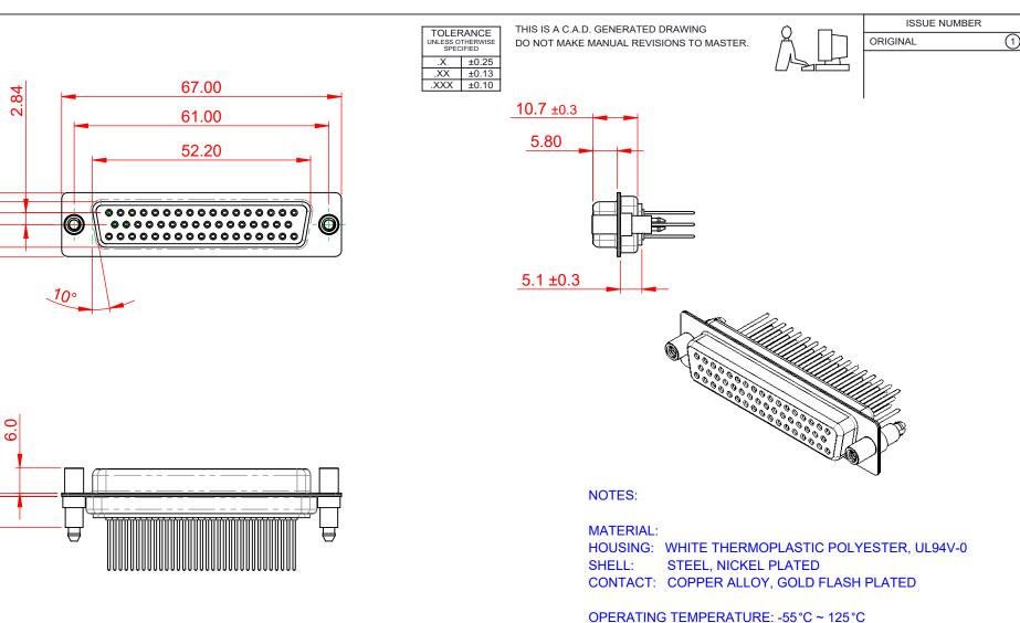
**CURRENT RATING: 5A PER CONTACT** CONTACT RESISTANCE:  $25m\Omega$  MAX. INSULATOR RESISTANCE: 5000MΩ min. DIELECTRIC
