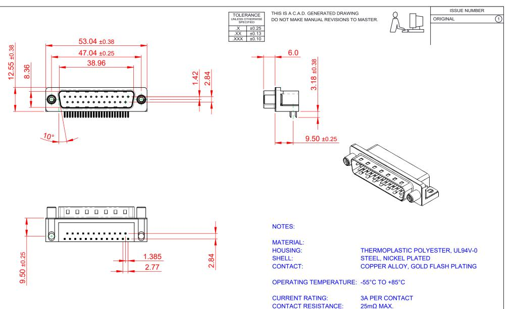
**INSULATOR RESISTANCE:** 5000MΩ min.
