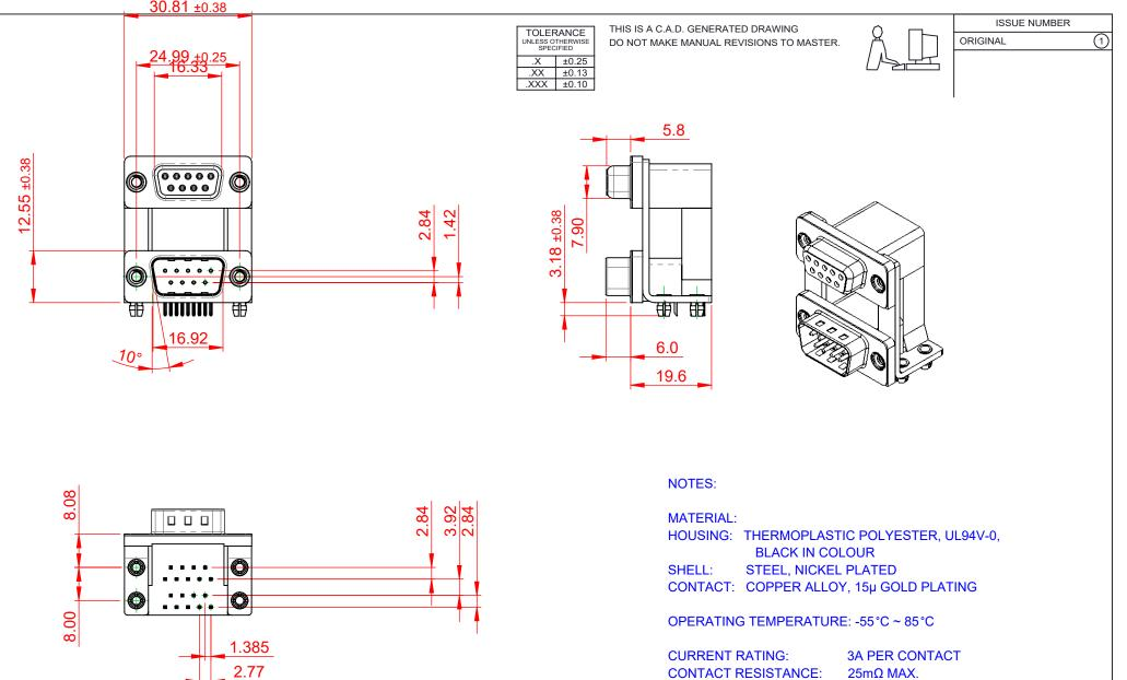
INSULATOR RESISTANCE: 5000MΩ min. DIELECTRIC
