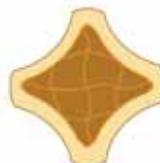
Sezione del conduttore crimpato ottenuta con attrezzo Molex a crimpare con 4+4 tacche Codice 8500.7930.0
