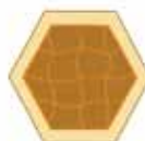
Sezione del conduttore crimpato ottenuta con attrezzo Molex a crimpare meccanico Codice 8500.7960.0 e l'attrezzo idraulico Codice 8500.7990.0
