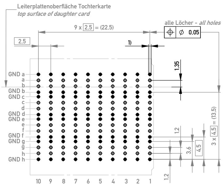
1) Ø 0.46 ± 0.05 Durchmesser des metallisierten Loches
