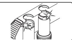
Überprüfen Sie ob die Dichteteile im Pen-Depot mit Tusche verschmutzt oder verklebt sind. Ist das der Fall dichtet das Depot nicht ausreichend, der Stift trocknet ein.
