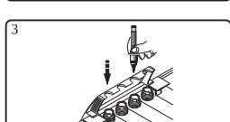
Bei Nichtbenutzung sollte die Verweildauer des Stiftes im Plotter-Pen-Depot zwei Stunden nicht überschreiten. Verschließen Sie den Stift nach der Benutzung mit der zugehörigen Verschlusskappe und lagern Sie ihn mit der Spitze nach oben.
