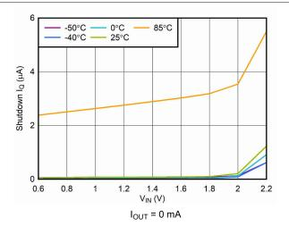
Figure 6-8. V<sub>IN</sub> Shutdown I<sub>Q</sub> vs V<sub>IN</sub>
