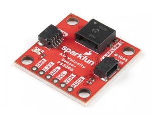
SparkFun Air Velocity Sensor Breakout - FS3000-1005 (Qwiic) © SEN-18377
