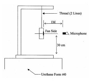
1 METER FROM MICROPHONE TO FAN INTAKE
