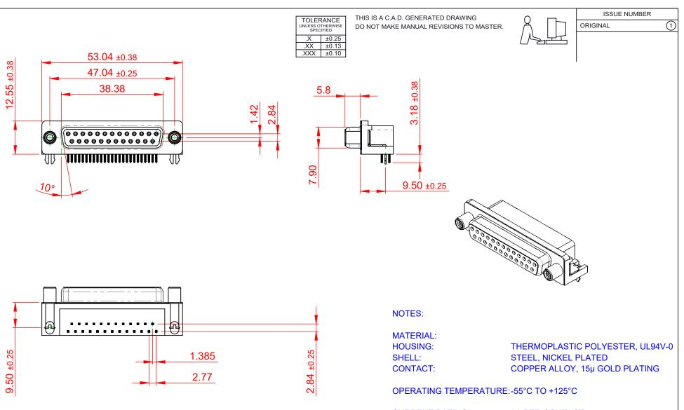
**CURRENT RATING: 3A PER CONTACT** CONTACT RESISTANCE: 25mΩ MAX. **INSULATOR RESISTANCE:** 5000MΩ min. DIELECTRIC
