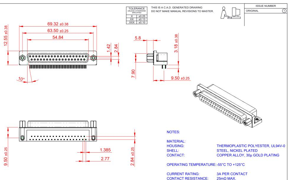
**INSULATOR RESISTANCE:** 5000MΩ min. DIELECTRIC
