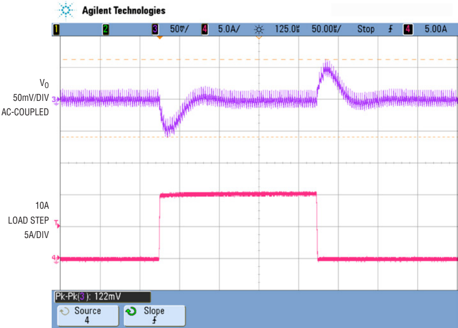
Figure 5. Load Step Transient Test ( V_{IN} = 12V , Total I_O : 10A to/from 20A)
