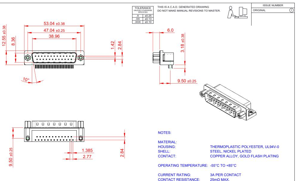
25mΩ MAX.  $5000M\Omega$  min. **INSULATOR RESISTANCE:**
