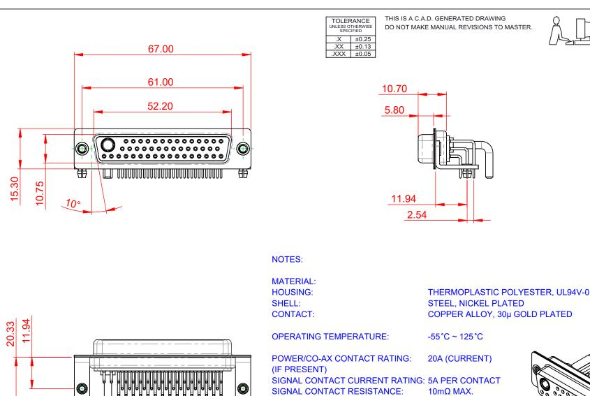
**INSULATOR RESISTANCE:** DIELECTRIC WITHSTANDING VOLTAGE: 5000MΩ min.
