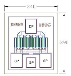
Chip dimensions : 340 X 390 microns Gate pad(GP) : 60 X 60 microns Drain pad(DP) : 70 X 90 microns Source pad(SP) : 70 X 95 microns Chip thickness : 75 microns
