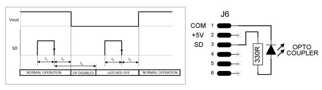
$t_1>= 5$ mS,  $t_2<= 25$ mS,  $t_3>= 200$ mS,  $t_4>= 500$ mS,  $t_5<= 600$ mS
